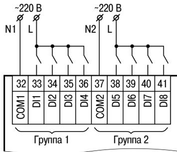
Рисунок 6 – Подключение дискретных датчиков с питанием 230 В
