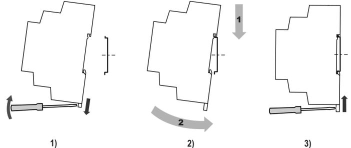
Рисунок 1 – Установка прибора
