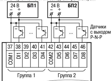
Рисунок 7 – Подключение датчиков с выходным транзистором р-п-п-типа
